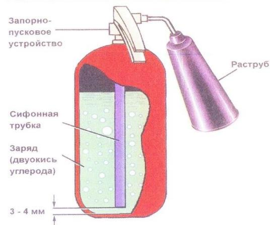
**ПРИНЦИП ДЕЙСТВИЯ** основан на вытеснении двуокиси углерода избыточным давлением. При открывании запорно-пускового устройства  $\text{CO}_2$  по сифонной трубке поступает к раструбу.  $\text{CO}_2$  из сжиженного состояния переходит в твердое (снегообразное). Температура резко (до  $-70^\circ\text{C}$ ) понижается. Углекислота, попадая на горящее вещество, изолирует его от кислорода
